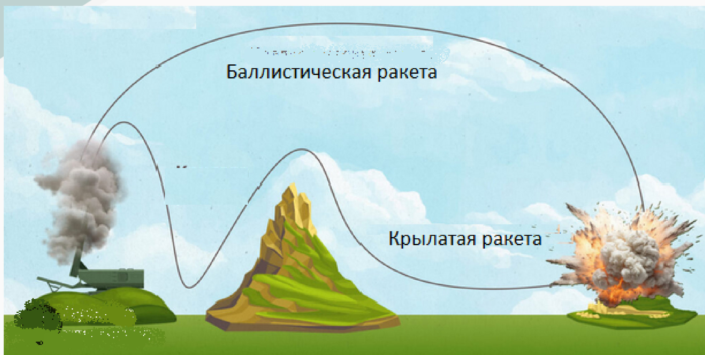
Рис. 1. Разница траекторий полета баллистической и крылатой ракеты
